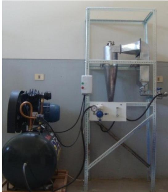
**Figura 20-** Prototipo de lecho fluidizado de tipo surtidor de acero inoxidable.
