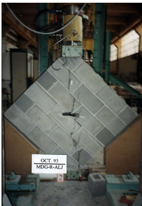
Figura 10 – Vista de la falla de un murete armado sometido a compresión diagonal.
